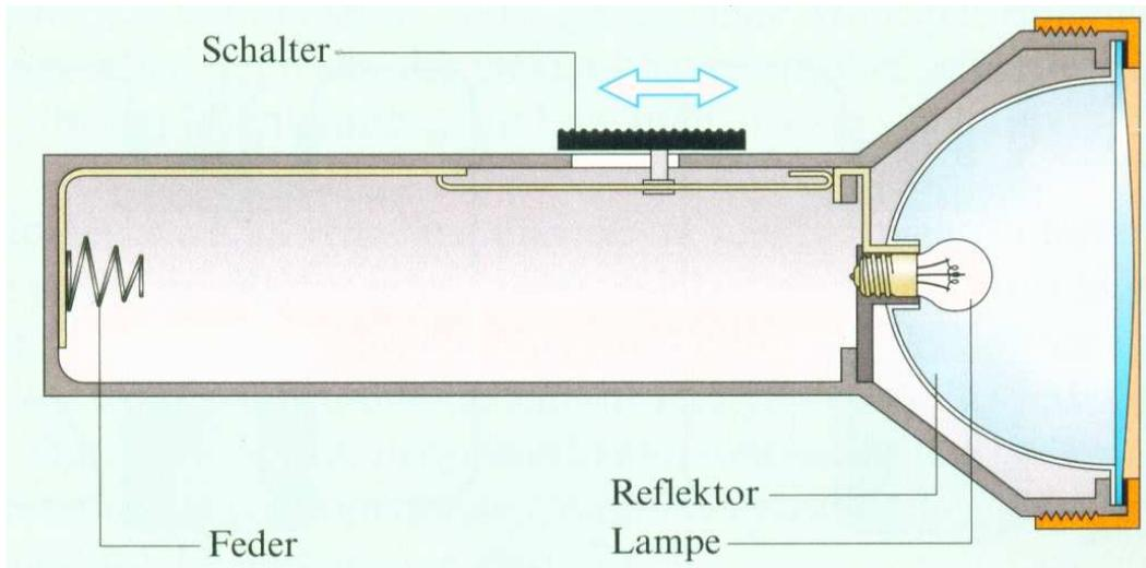
Ergänze im Bild benötigte Kabel und zeichne den elektrischen Stromkreis farbige ein.
