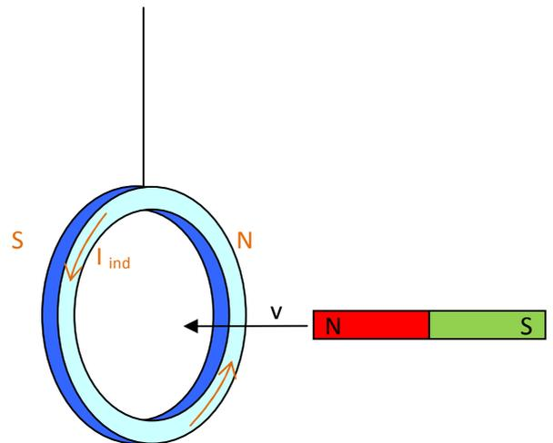
elektrische Strom verursacht ein Magnetfeld, das nach Regel von Lenz die Ursache der Induktion (d.h. das Hinbewegen des Stabmagneten) zu hemmen versucht. Also werden sich Kupferring und Stabmagnet wechselseitig abstoßen.
