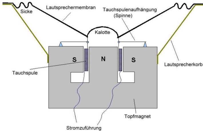
Querschnitt durch einen dynamischen Lautsprecher
