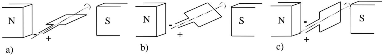
Was passiert, wenn man die Drahtenden der Leiterschleife mit dem so genannten Polwender (auch Kommutator genannt) verbindet und der elektrische Strom über zwei Schleifkontakte zugeführt wird?
