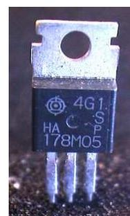
Als Lager dienen Leistungstransistoren, Spannungsregler oder Ähnliches. Der mittlere Anschluss ist meist mit dem Gehäuse verbunden und kann mit Krokodilklemmen an die Stromquelle gelegt werden. Im Versuch standen die Lager auf Moosgummi, Styropor geht auch. Wichtig ist, dass die Lager aus Metall sind, um den Strom zur Achse zu leiten. Und sie sollen größer sein als die Achse, damit sich alles schön locker drehen kann.
