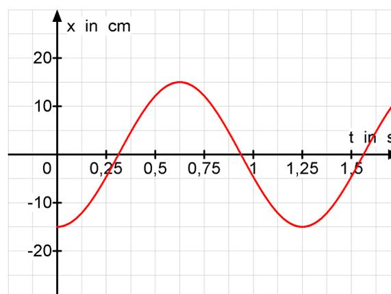
3. Das  $t - x$  - Diagramm zeigt die Schwingung eines stark gedämpften Federpendels. Die schwingende Masse beträgt dabei  $75 \text{ g}$ .
