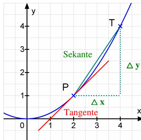
$$m_P = \lim_{\Delta x \rightarrow 0} \frac{\Delta y}{\Delta x} = \lim_{x_T \rightarrow x_P} \frac{f(x_T) - f(x_P)}{x_T - x_P} = \lim_{x \rightarrow x_P} \frac{f(x) - f(x_P)}{x - x_P} \quad (\text{so genannter Differenzialquotient})$$
