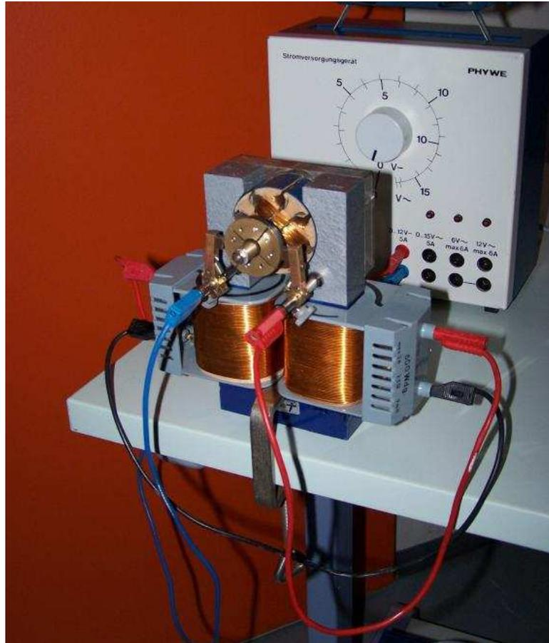
**Bauen Sie einen so genannten Hauptschlussmotor auf, bei dem die Feldspulen und die Spulen des Rotors (Ankers) in Reihe an die Spannung von 12 V angeschlossen sind. (Schaltplan auf der Rückseite!)**
